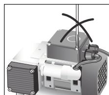
Der Anschlussdeckel darf wegen Stromschlaggefahr nicht geöffnet werden, wenn das Gerät unter Netzspannung steht. Den Anschlussdeckel darf nur eine qualifizierte Servicestelle öffnen.
