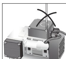
La tapa de conexión, identificada por el distintivo que figura al pie, sólo debe abrirse por personal cualificado una vez desenchufado el cable de red (corte de corriente). Rogamos observe las normas, así como las demás reglas sobre seguridad técnica y sanidad laboral.
