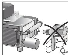
Es dürfen keine Gegenstände oder Flüssigkeiten in die Lüftungsschlüsse gelangen. Es könnte dadurch ein Blockieren des Motors oder ein Stromschlag verursacht werden.
